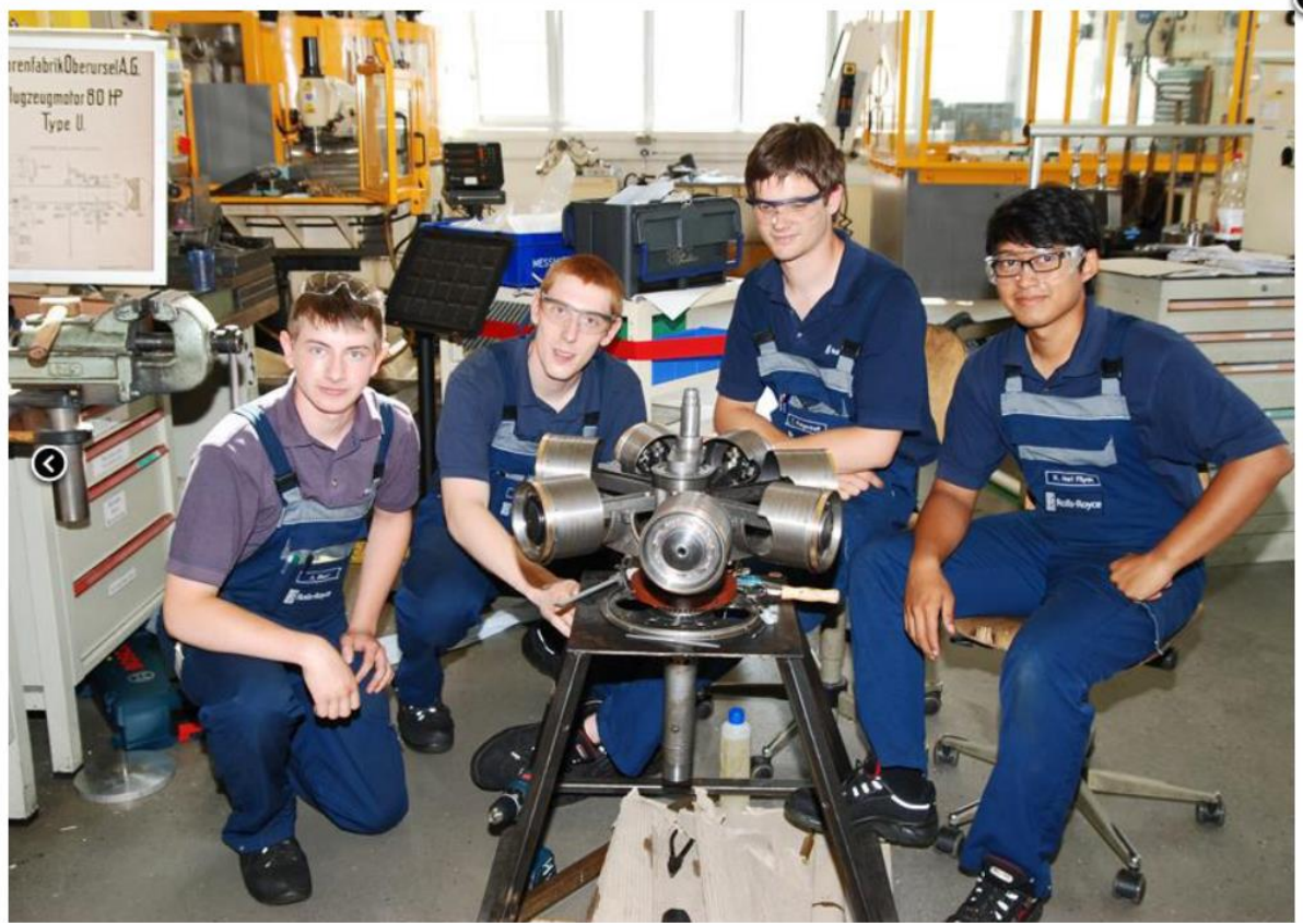
Kolben und Einlassventile sind montiert
