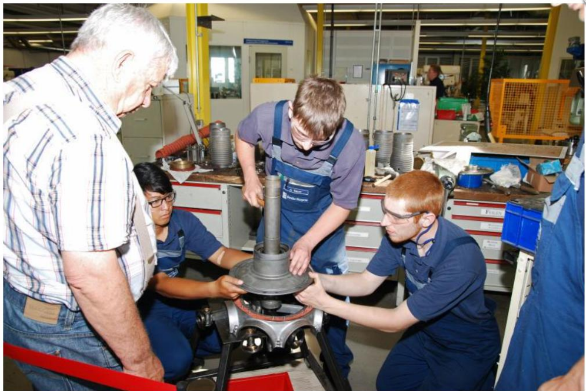
Die Rückseite des Motors wird montiert
