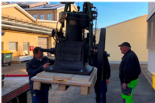
Es passt zusammen – Festziehen der Schrauben M20
