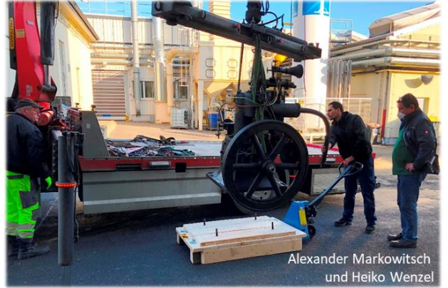
Abladen und Absenken auf das Motor-Podest
