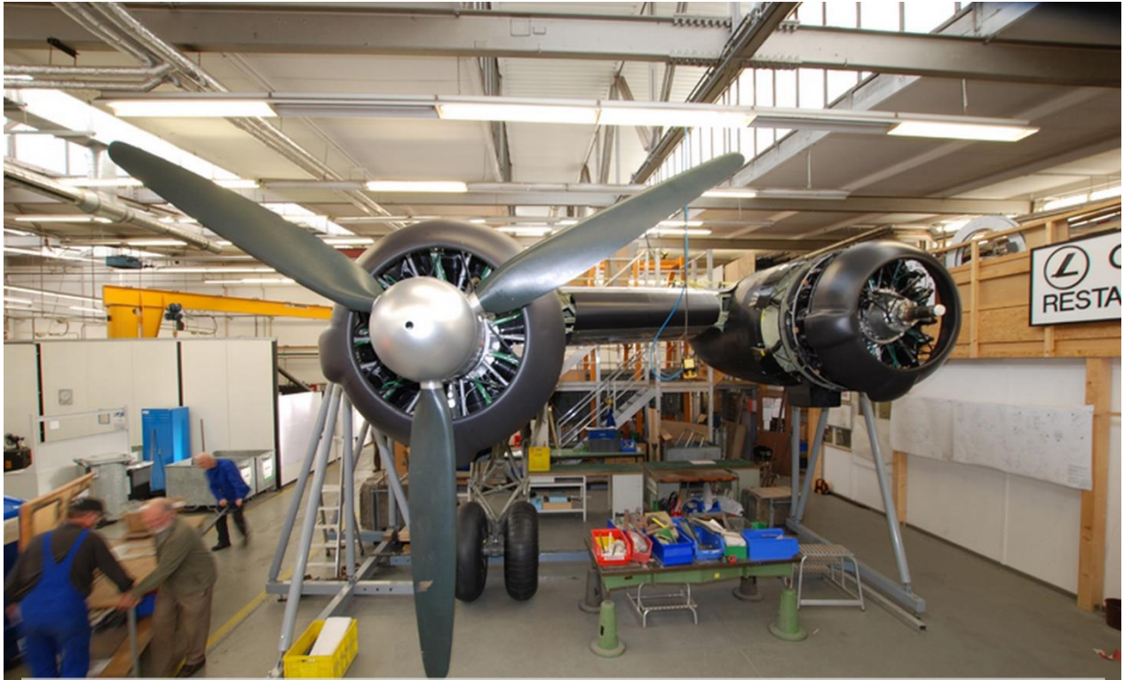
2010 - Die verfügbaren Motoren werden in Bremen eingebaut
