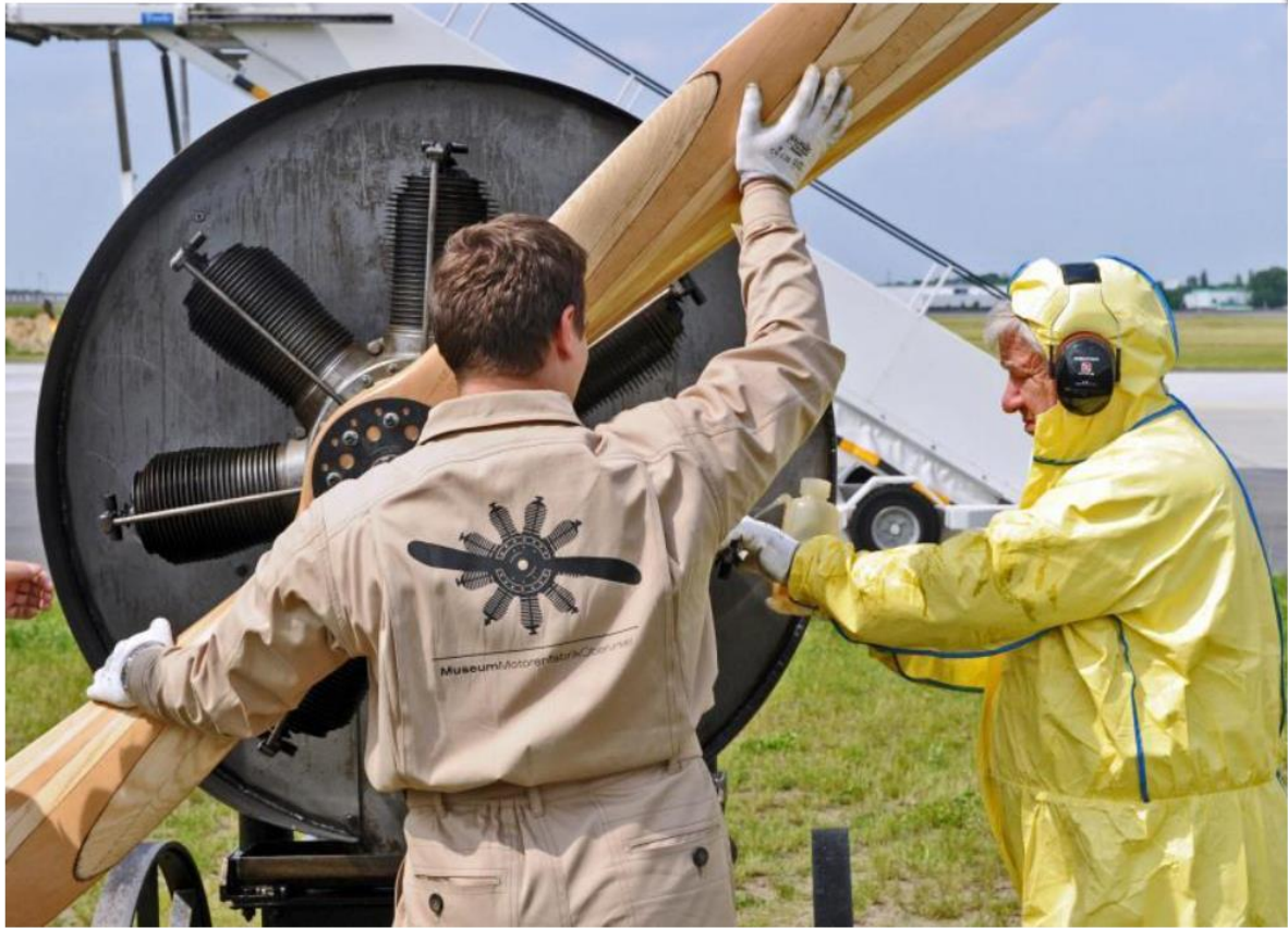
Bild 09 - In die Zylinder wird Kraftstoff gespritzt
