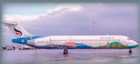
Die Boeing 717-200 wird mit BR715 Triebwerken ausgerüstet
