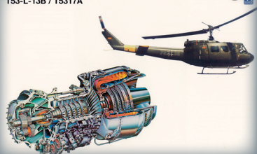
Das Triebwerk T-53 für die Bell UH1D
