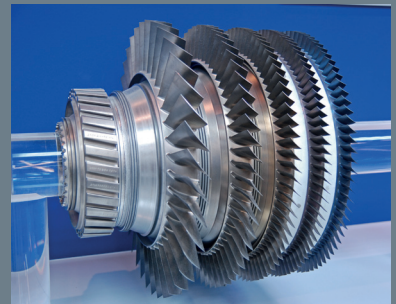
Die Blisk Fertigung wird eingeführt
