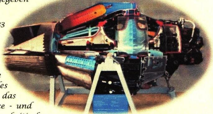
Das überlassene Schnittmodell des Triebwerks Allison J33-A-35 war von den Lehrmittelwerkstätten der Luftwaffe in Fürstfeldbruck für die Ausbildung angehender Jet-Piloten und von Triebwerks- und Flugzeugmechanikern angefertigt worden. Zwischenzeitlich in private Hände gelangt, konnte der Geschichtskreis Motorenfabrik Oberursel das Triebwerk im Jahr 2010 erwerben und stellte es zunächst dem Luftwaffenmuseum in Berlin-Gatow als Leihgabe für zehn Jahre zur Verfügung.
