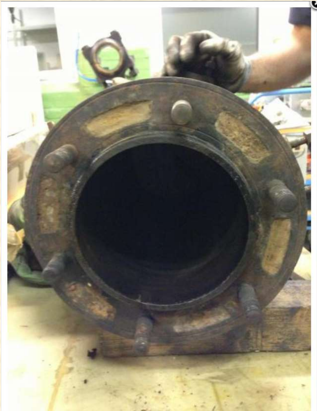
Bild 20 - Die Kühlkanäle im Zylinder sind verstopft
