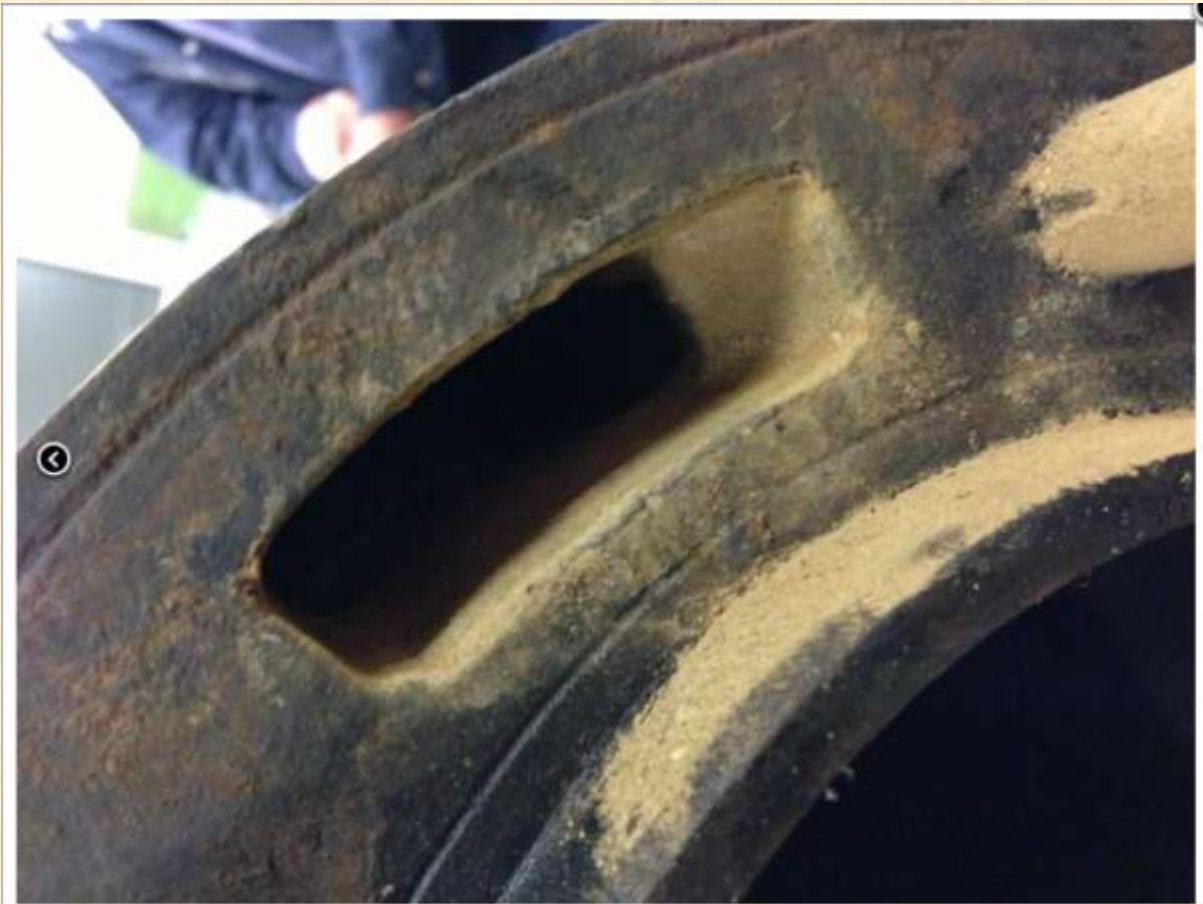
Bild 21 - Die Kühlkanäle konnten aber leicht gereinigt werden
