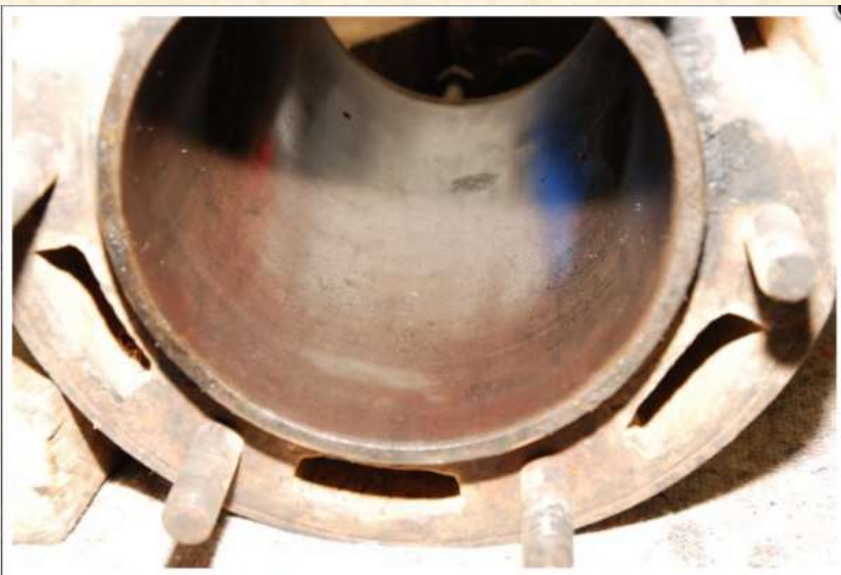
Bild 22 - Die Zylinderlaufbahn ist gut
