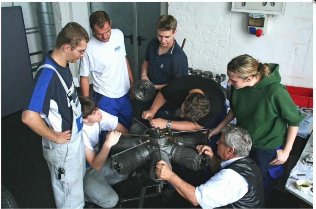
Bild 11 - Zuletzt wird die Motorsteuerung eingebaut
