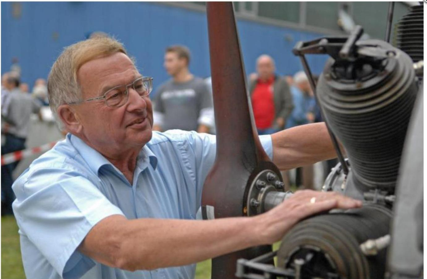
Bild 16 - Erich Auersch überprüft nach dem Lauf die Temperatur der Zylinder
