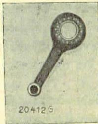
Die Pleuelstange ist aus einem Stück Chromnickelstahl hergestellt und besitzt oben ein geschlossenes Auge mit Bronzebüchse für den Kolbenbolzen. Das Pleuelzapfenende ist ebenfalls geschlossen ausgeführt und zur Aufnahme eines Rollenlagers für den Pleuelzapfen eingerichtet. Der Pleuelstangenschaft hat I-förmigen Querschnitt.
