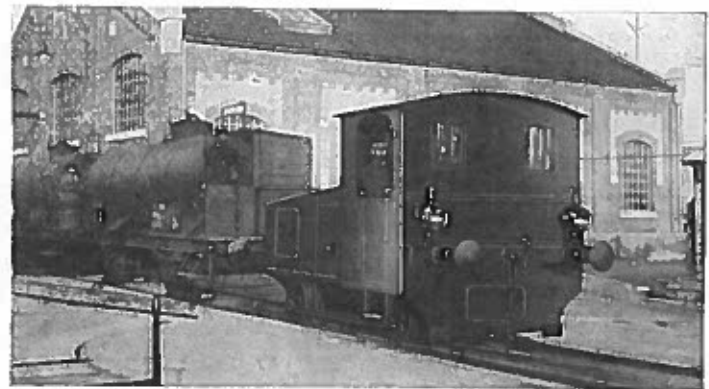
Oberurseler Motor-Lokomotiven, normalspurig, für Rangier-Betrieb.
